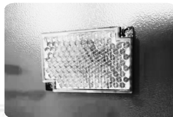
Optyczny czujnik zabezpieczający podnośnik w przypadku utraty synchronizacji
